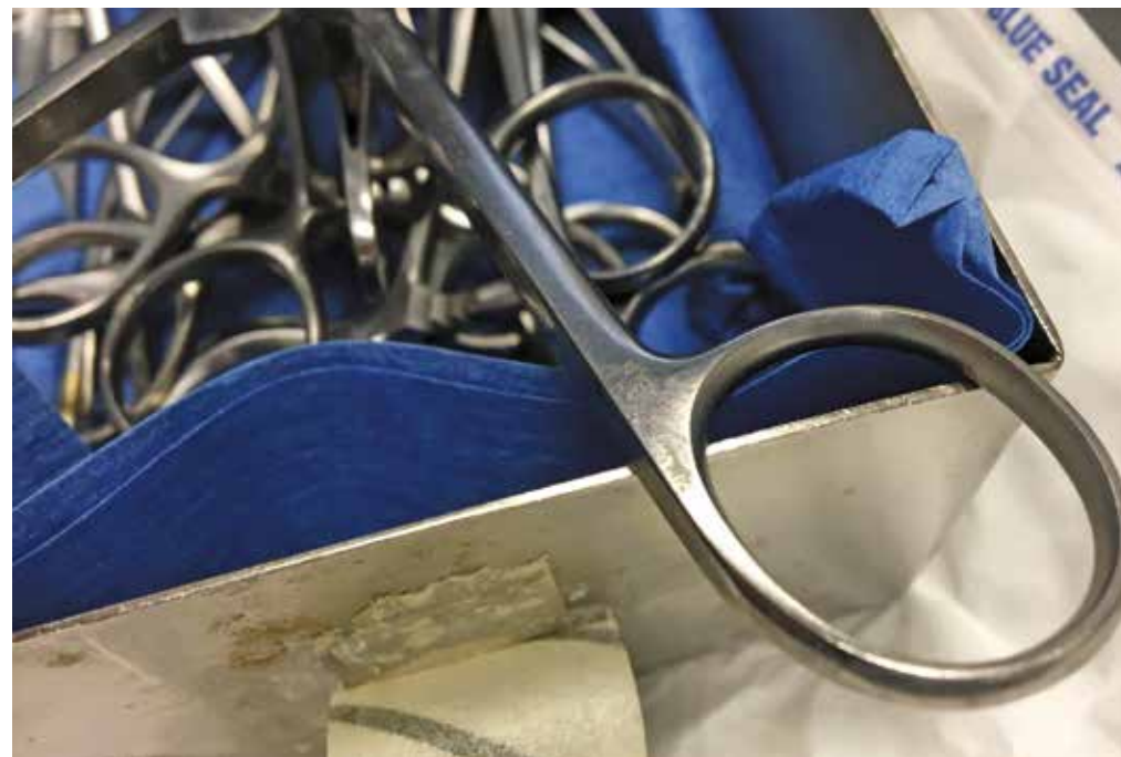
[Afbeelding] Zichtbare kalk- en corrosieresten op instrumentarium - © Sandra Roubos.
